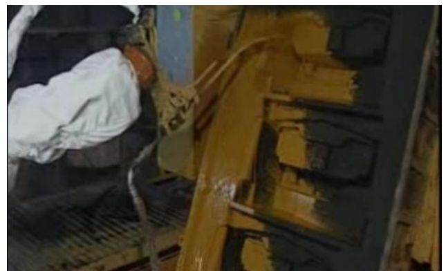
Benetzung der Sandkokillen mit Schlichte
