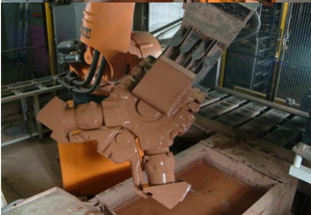
Entnahme des Sandkernes aus dem Tauchbecken
