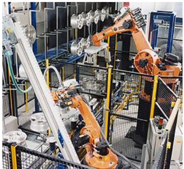
Handhaben und Bearbeiten unterschiedlicher Leichtmetallräder
