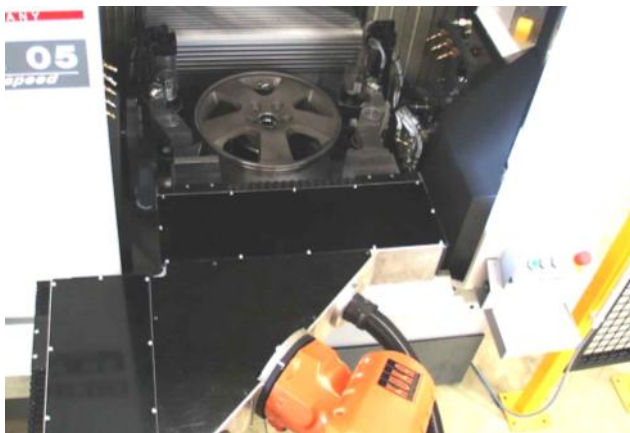
Zuführung der Räder zum nachfolgenden Prozess
