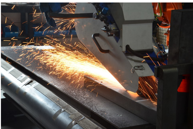
Automatisches Ausschleifen der Innenknicke
