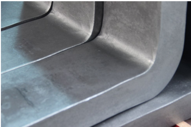
Innenknick - Vor der Bearbeitung
